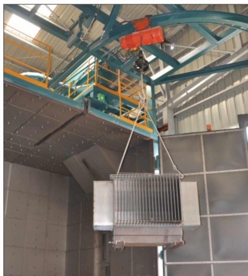
Hệ thống phun bi làm sạch Shot plating machine
