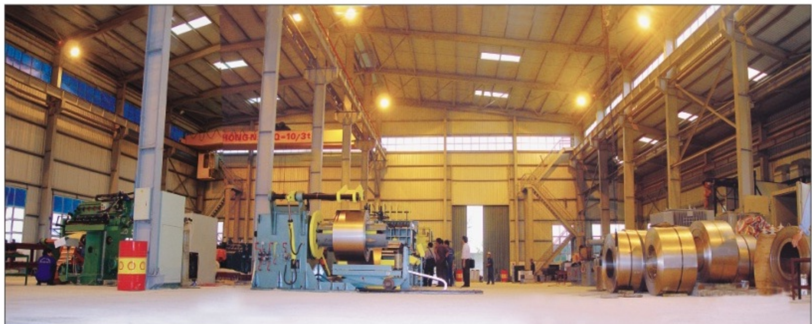
Khu vực cắt xả tôn và chế tạo vỏ máy Steel sheet slitting, corrugated steel tank forming and welding area
