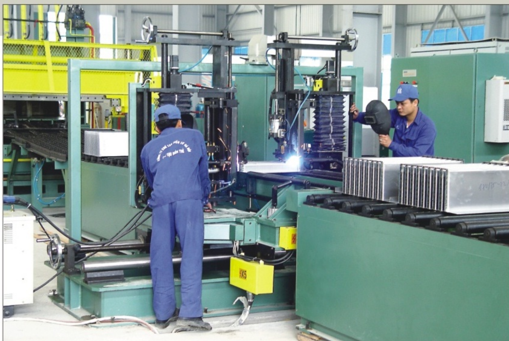
Dây chuyền chế tạo vỏ máy biến áp Corrugated Steel Tank Forming and Welding Line
